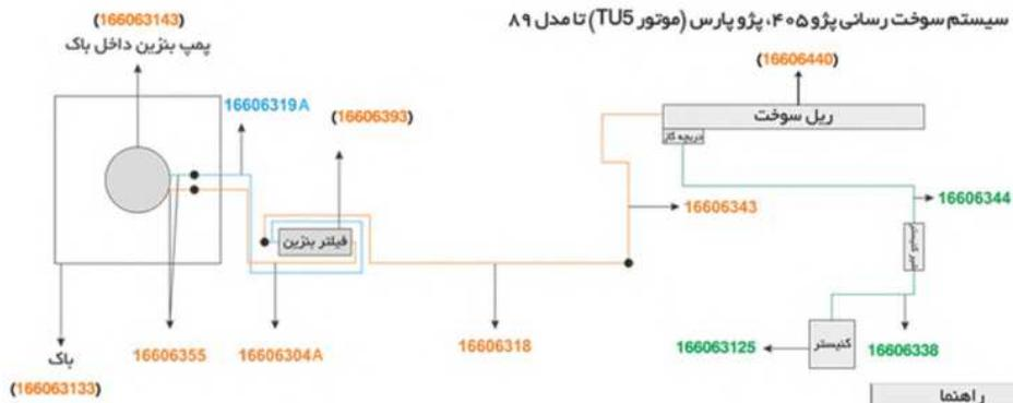
نکته: با توجه به اینکه شیلنگهای (۱۶۶۰۶۳۱۹ A) در حال فشار می‌باشند به منظور جلوگیری از خم شدن شیلنگها یا شکسته شدن زانده ورودی و خروجی پمپ بنزین از شیلنگ (فراخوان) ۱۶۶۰۶۳۱۹B استفاده میگردد. و یا (۱۶۶۰۶۳۱۹B) استفاده میگردد.
