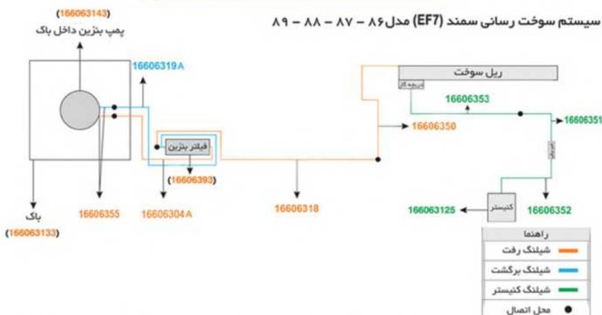
نکته: با توجه به اینکه شیلنگ‌های (۱۶۶۰۶۳۱۹A) در حال فشار می‌باشند به منظور جلوگیری از خم شدن شیلنگها یا شکسته شدن زانده روودی و خروجی پمپ بنزین از شیلنگ (فرآخوان) (۱۶۶۰۶۳۰۴B) و (۱۶۶۰۶۳۰۴B) استفاده می‌گردد.
