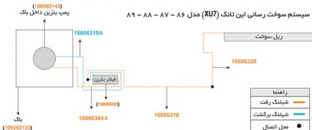
نکته: با توجه به اینکه شیلنگ‌های (16606304A) در حال فشار می‌باشند به منظور جلوگیری از خم شدن شیلنگ‌ها یا شکستن زانده ورودی و خروجی پمپ بنزین از شیلنگ (فراخوان) (166063055) استفاده می‌گردد.
