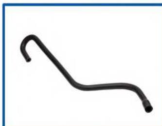
شیلنگ بخار روغن از درب سوپاپ
